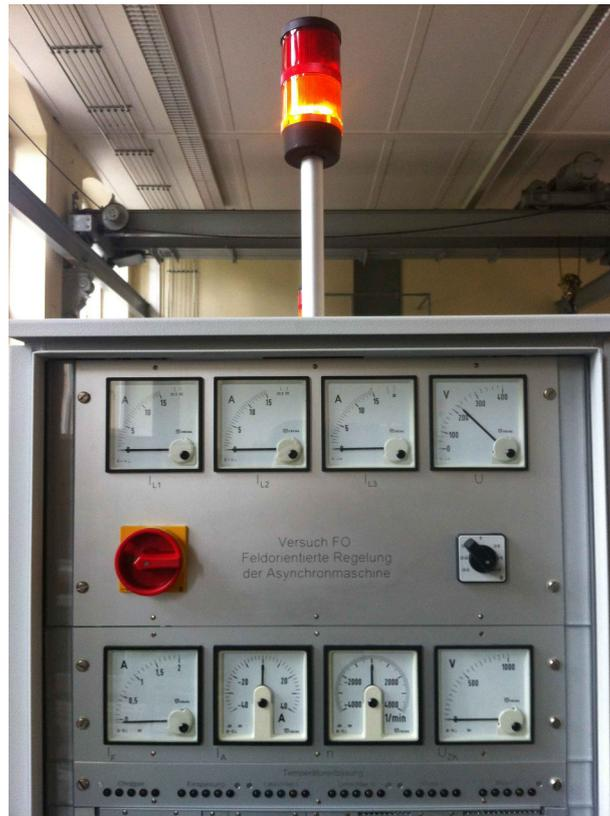
Abbildung 1.2.: Kopf des Umrichterschrankes mit Signalleuchte und Analoganzeigen für die Eingangsströme und Spannungen mit Wahlschalter, Feldstrom, Ankerstrom, Drehzahl und Zwischenkreisspannung sowie Temperaturerfassung für den Bremschopper, Einspeisung, Umrichter 1 und 2 sowie Motor 1 und 2
